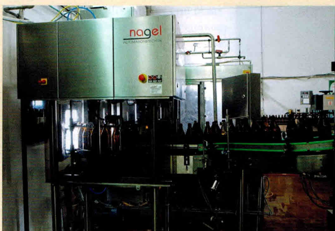
Die Vollinspektionsmaschine passt perfekt in die schmale Lücke zwischen Flaschenwaschmaschine und Füller
