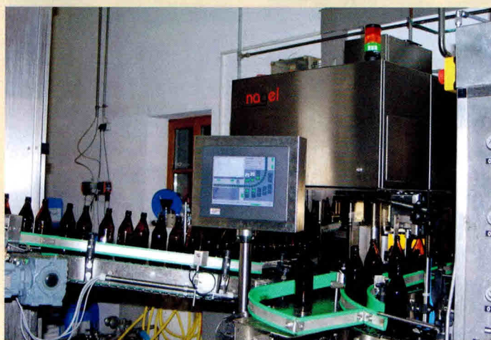
Kurz nach der Waschmaschine laufen die vereinzelt Flaschen in die Inspektionsmaschine ein und werden rundum überprüft
